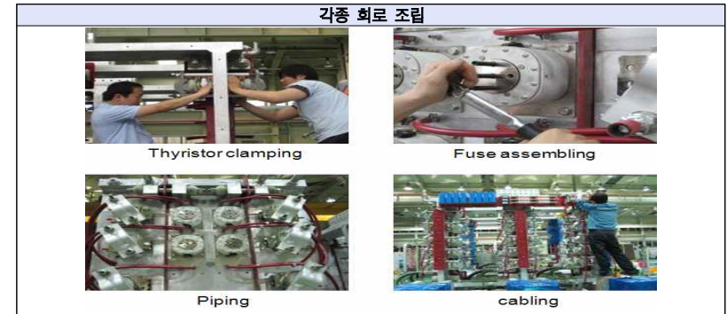
[그림4-58] 컨버터 전기부품 및 각종 회로 조립
