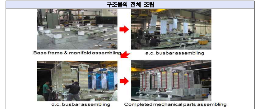
[그림4-57] 컨버터 구조물의 전체 조립
