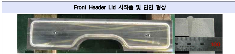
[그림4-26] 전자빔용접에 의한 Front Header Lid 시제품 및 단면 형상
