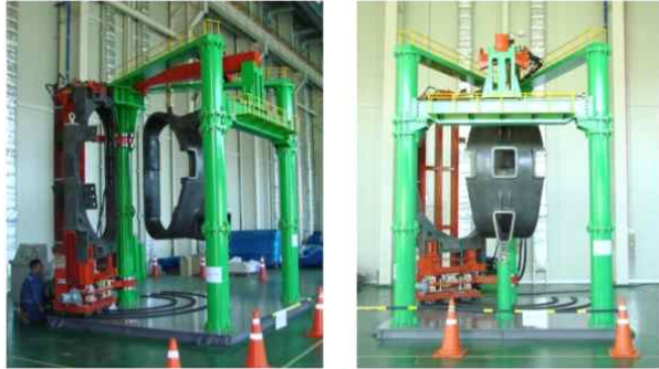
[그림4-33] 1/5 축소형 Mock-up 대상 조립장비
