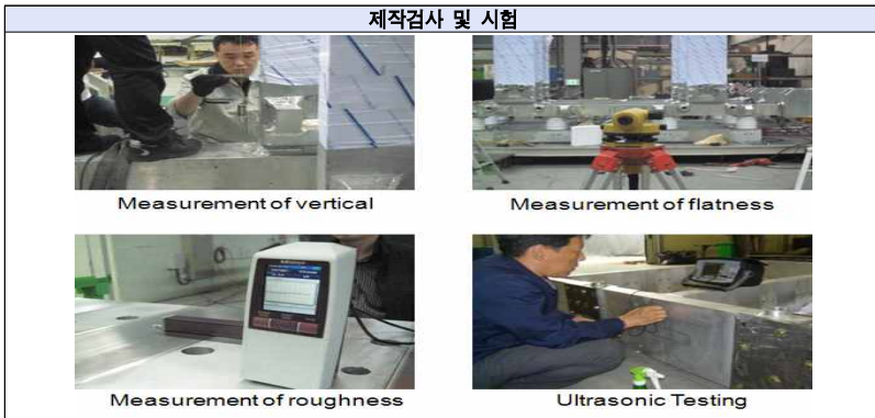
[그림4-56] 컨버터 구조물의 제작검사 및 시험
