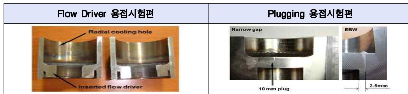
[그림4-27] Flow Driver 및 Plugging 용접시험편의 최종 용접 단면 형상
