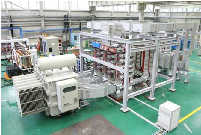
[그림4-50] AC/DC 컨버터의 R&D 제작 및 시험
